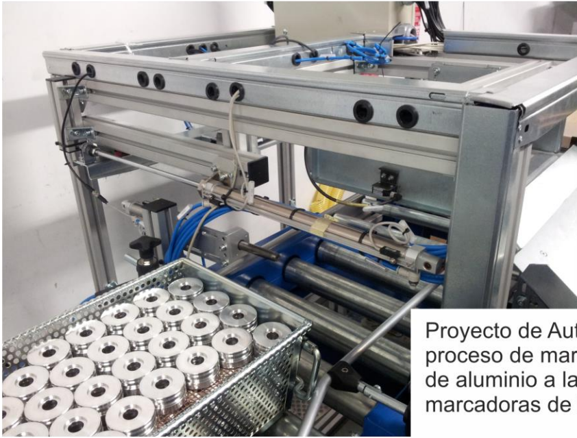
Entrada al sistema de cajas con 6 filas de casquillos que se descargan por una rampa a la cinta de entrada de las marcadoras.
