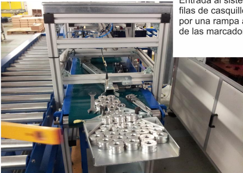
Proyecto de Automatización de proceso de marcaje de 6 casquillos de aluminio a la vez mediante marcadoras de impacto.
